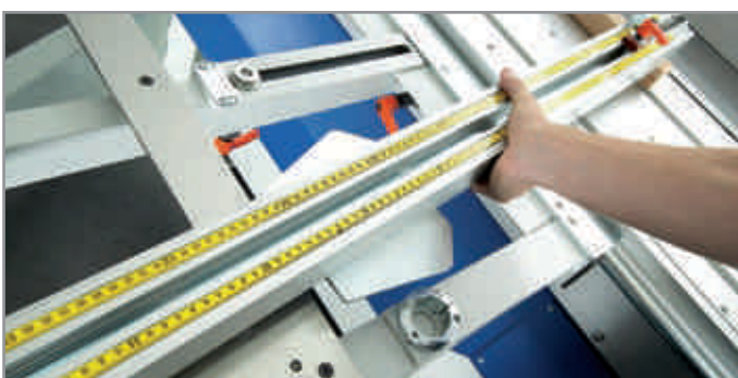
Serrage confort pour butée longitudinales système auto-bloquant sans outillage
