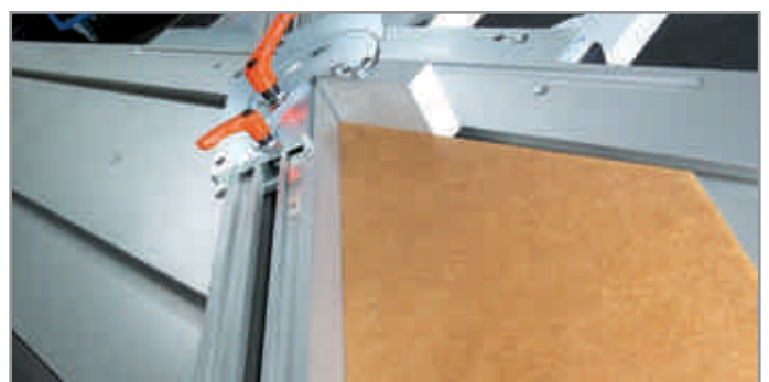
Butée auxiliaire pour onglet la solution au problème d'assemblage d'onglets aigus et obtus
