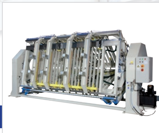
Presse à encoller 3 faces électro- hydraulique
