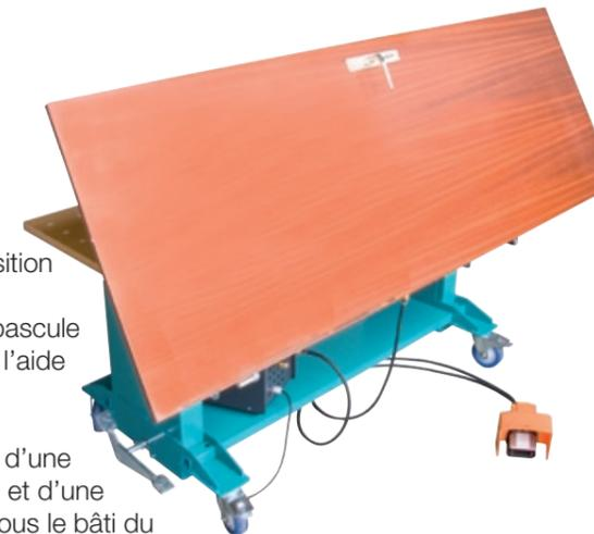
L'ensemble se compose d'une pompe à vide électrique et d'une structure en acier fixée sous le bâti du SUPPORTER. Deux ventouses, sur supports coulissants et orientables, sont montées sur la traverse. Les ventouses sont équipées d'une commande à déclenchement par contact, qui crée le vide et maintient l'élément. Une commande au pied permet de libérer la pièce.
